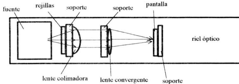
**Medición de la distancia focal de una lente mediante rayos paralelos**
